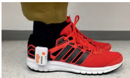
Sensorschuh misst verschiedene Parameter des Gangbilds
